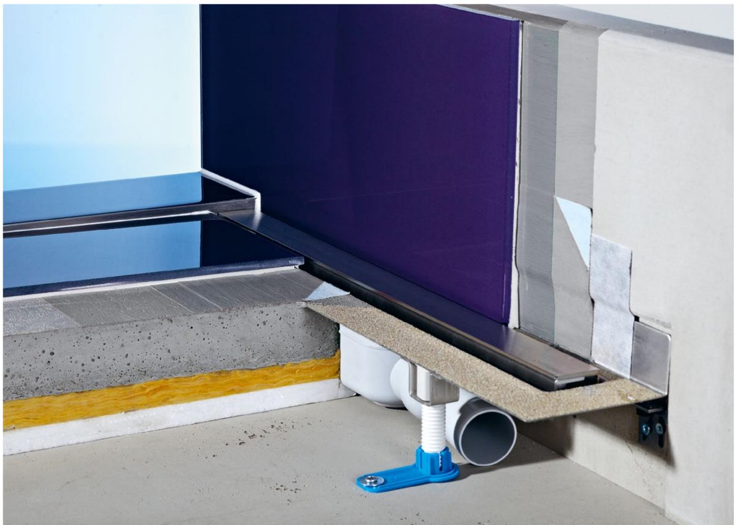
Wird die AIV durchgehend ohne Aufkantung am Ablauf und ohne Silikonfuge mit der Duschrinne verbunden, kann kapillar eingedrungene Feuchtigkeit zuverlässig diffundieren und abtrocknen.
