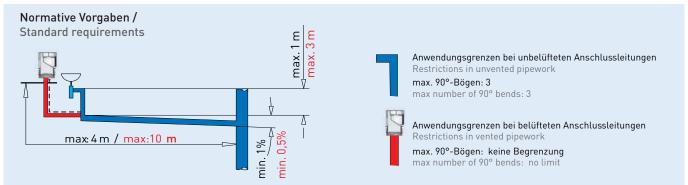
Unter Absatz 6.5.3 (Planung mit Belüftungsventilen für Schmutzwasserfallleitungen) ist festgelegt: "Belüftungsventile dürfen verwendet werden um Einzelfallleitungen zu belüften. Sie müssen mit  $Q_a*(l/s) >= 8 \times Q_{tot}$ \*\* bemessen sein."
