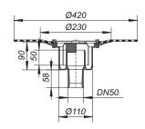
Medidas de la escotadura: 150 x 180 mm Medidas de perforación: d: 130 mm
