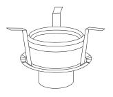
En la prevención de incendios, los sumideros de plástico con tubo de desagüe vertical se consideran pasatubos y pasos de forjado que requieren un aislamiento. Lo mismo puede decirse de los sumideros para cubierta instalados sobre cubiertas planas, toda vez que deba aplicarse la norma DIN 18234. Dallmer ha resuelto ambas tareas con un sistema de montaje que puede instalarse de manera rápida, sencilla y sin herramientas.
