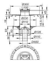
Medidas de la escotadura: 150 x 180 mm Medidas de perforación: d: 130 mm
