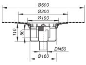
Medidas de la escotadura: 200 x 240 mm Medidas de perforación: d: 180 mm
