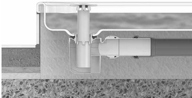
Standrohr ausgefahren – Wasser wird angestaut
