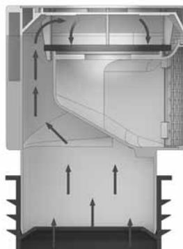
Bei Überdruck im System dichtet das Belüftungsventil ab. Es können keine Kanalgase austreten.
