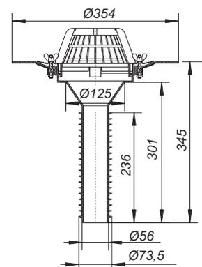
Sanierungsabläufe 63 T in Sonderlängen 590 mm (DN 70 und DN 150)
