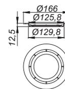
**DALLMER Schlauchanschlussbogen mit Rohrbelüfter zu 405**
