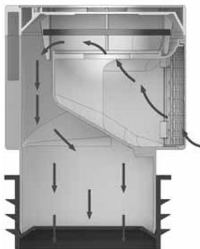
Bei Unterdruck im Rohrsystem öffnet das Belüftungsventil und die einströmende Luft bewirkt den Druckausgleich.
