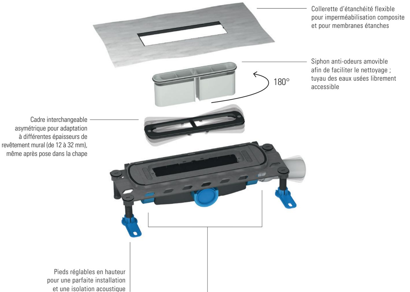
Raccord d'écoulement pour un positionnement variable (sans outils) sur trois côtés, rotule mobile pour le raccordement sans tension au tuyau des eaux usées
