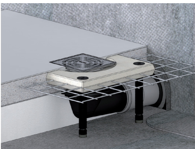
Wpust attykowy z korpusem wpustu balkonowego 83, przedłużką CeraDrain i nasadą tarasową
